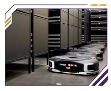
使用自主移動機器人(AMR)後,同事們現在可以站在工作站輕鬆執拾貨品,不再需要在物流中心內走來走去。這有助於節省大量同事的行走時間,防止同事過度勞累,並降低工作中潛在的安全風險。
