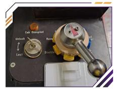
當車長選擇 Shutdown/Standby/CM/Auto模式時,在 Mode Selector上的磁石與RM顯示器上的磁石異極相吸,故此不會顯示RM模式。
