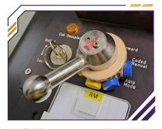
當車長選擇 Forward/Reverse (即RM模式)時,在 Mode Selector上的磁石與 RM 顯示器上的磁石同極相拒,故此顯示 RM 模式。
