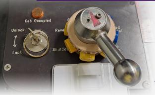
當車長選擇關機(Shutdown)、待命(Standby)、半自動(CM),或自動模式(Auto Mode) 時,由於裝置於模式選擇器 (Mode Selector)上的磁石與RM顯示器上的磁 石異極相吸,所以不會顯示RM模式。
